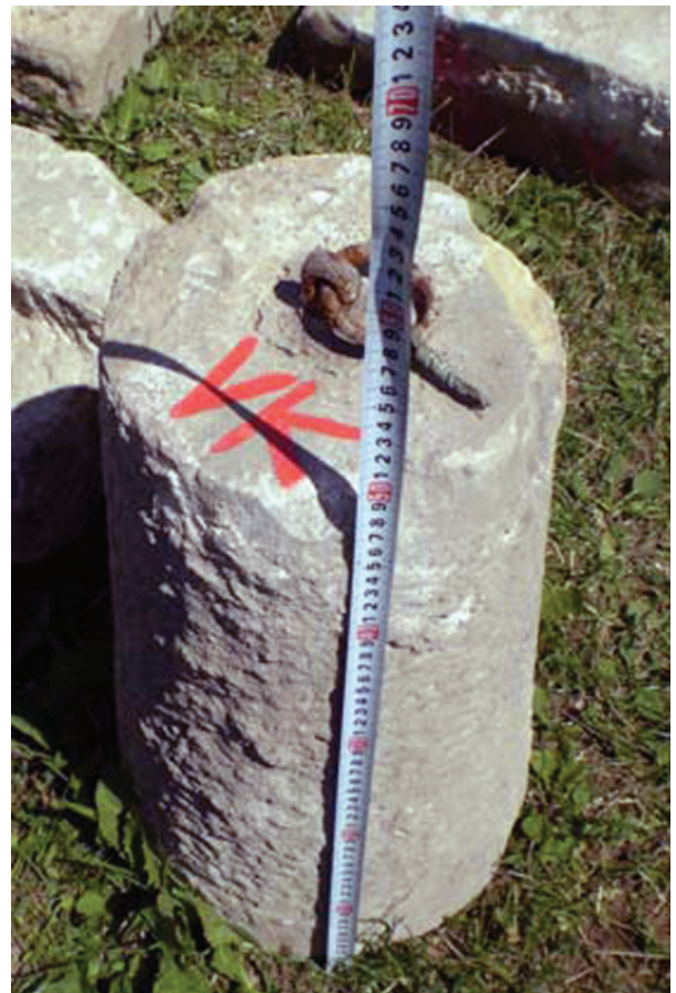
Sl. 6. Ključni kamen vrha kupole, visine 50 cm, što je dodatno potvrdilo pretpostavke inženjera o debljini kupole, ali i na osnovu iskustva sa sličnim strukturama (kao što je kupola na džamiji u Počitelju)
