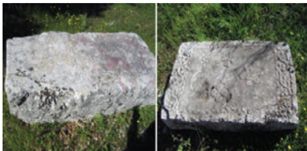
Sl. 2. i 3. Površina kamena prekrivena biološkim obraštajem
