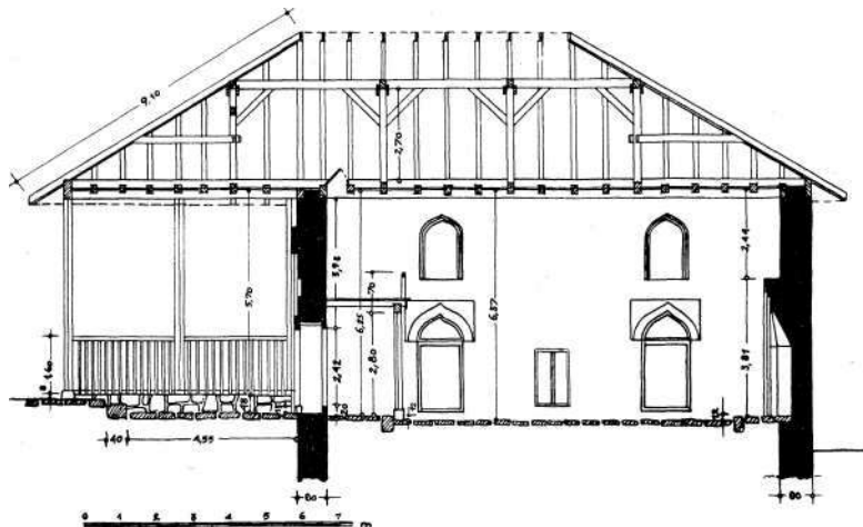
Sl. 11 Džamija na Ustikolini — uzdužni presjek (nacr. ing. E. Dimitrijević, 1953)
