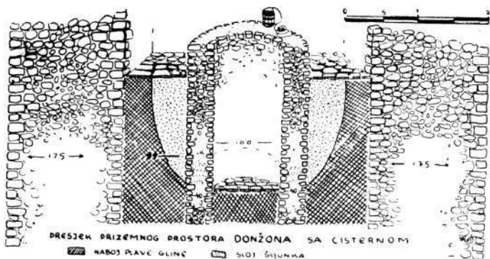
Sl. 7 Presjek prizemnog prostora donžona sa cisternom
